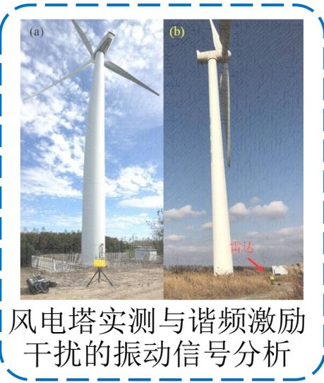
风电塔实测与谐频激励干扰的振动信号分析
