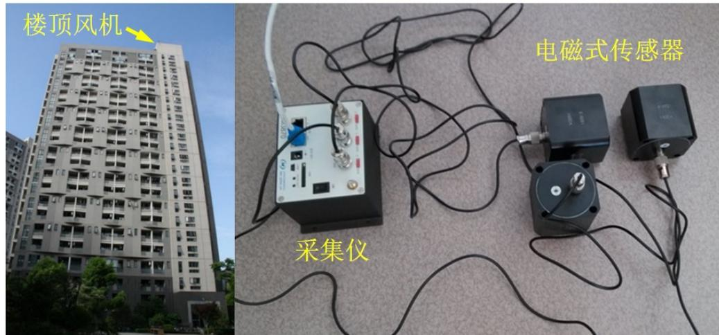
屋顶风机所在建筑振动实测
